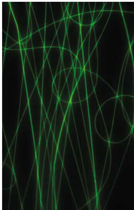
Fluoreszenzmikroskopische Aufnahme der Fasern für das Vlies. Foto: Benedikt Göttel
