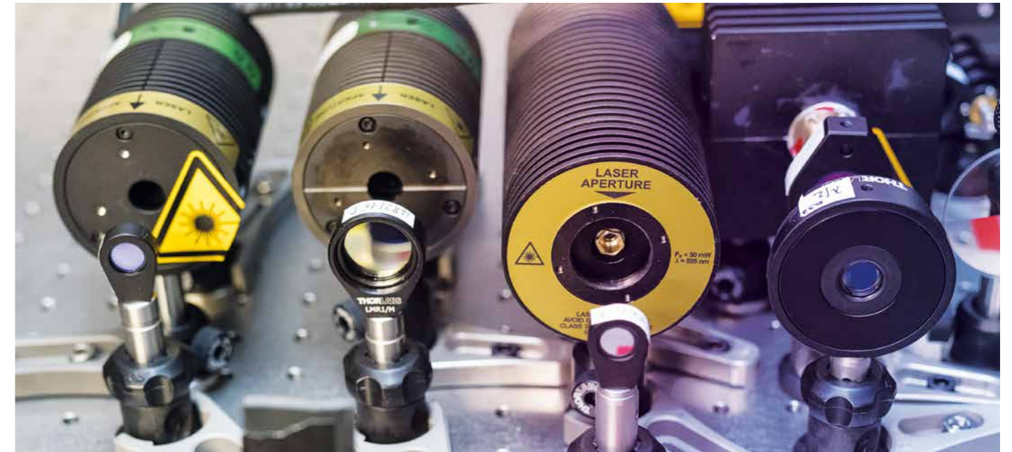
Diodenlaser unterschiedlicher Wellenlängen werden zur Anregung fluoreszenter Farbstoffmoleküle verwendet. Foto: Jens Schlüter
